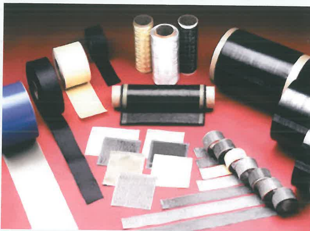
Råmaterial för komposittillverkning. Längst bak syns rullar med aramid-, glas- respektive kolfiber. Till höger i bild syns rullar med förimpregnerad (prepreg) kolfibertape. Framför fiberrullarna ligger förimpregnerade vävar och till vänster rullar med limfilm.
