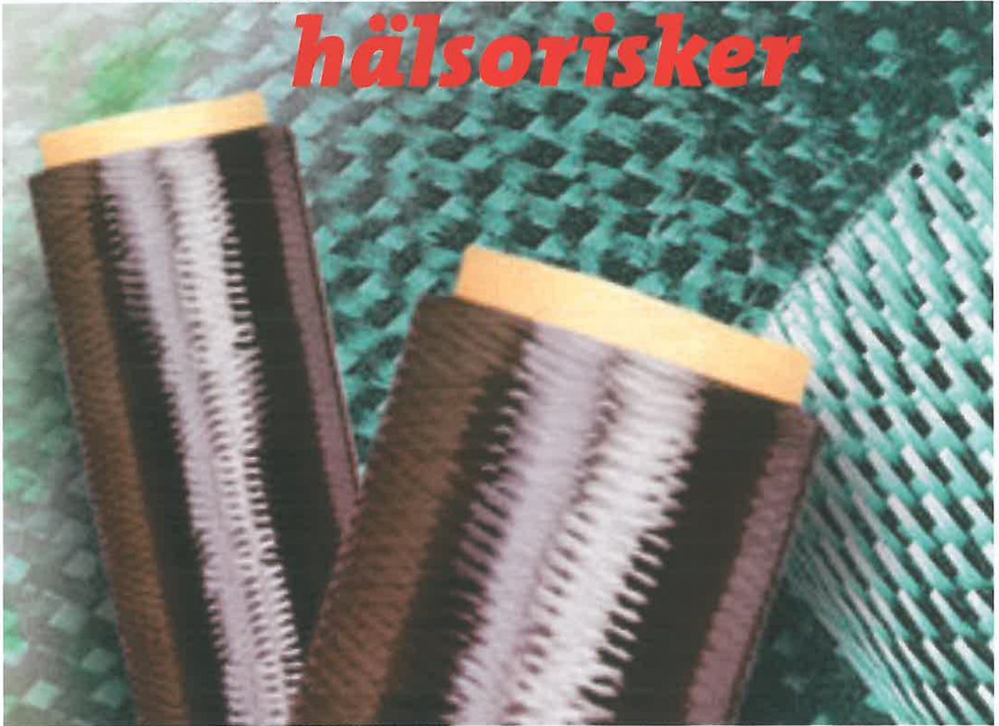
Kolfiberrullar och vävar av kolfiber. Ett kolfibergarn (s.k. roving) innehåller vanligen 3000, 6000 eller 12 000 fibrer och varje fiber har en diameter på ca 12 mm. I bakgrunden kolfiberväv.
